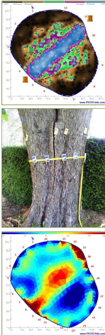
Figura 5. La tomografia di questo ippocastano evidenzia un'ampia zona centrale a velocità di diffusione sonora molto ridotta, forse eccessiva rispetto all'evidenza del cretto visibile dall'esterno. La tomografia elettrica chiarisce la netta separazione che sussiste fra l'area centrale a elevata resistività, coerente con la presenza del cretto osservabile, e le aree contermini non alterate.
