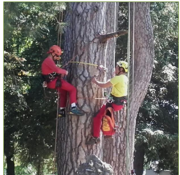
Figura 7. Tomografia sonora eseguita anche in quota.
